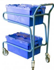
SERVANTE Pour bacs emboîtables 600 x 400 Ext : 860 x 430 x 1 055 Dim. utiles : 560 x 365 x 875 Ø Roues : 125 mm, 4 roues pivotantes dont 2 à frein. Poids : 13,0 kg
